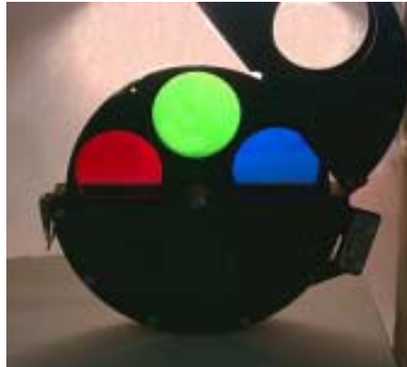
Fig.2 - Roda de Filtros, que é colocada entre o telescópio e o CCD. É utilizado um filtro de cada vez
